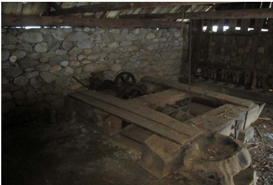
Fig.8. Teasc cu șurub central dispus în plan orizontal. Imagine din Muzeul în aer liber Sibiu.
