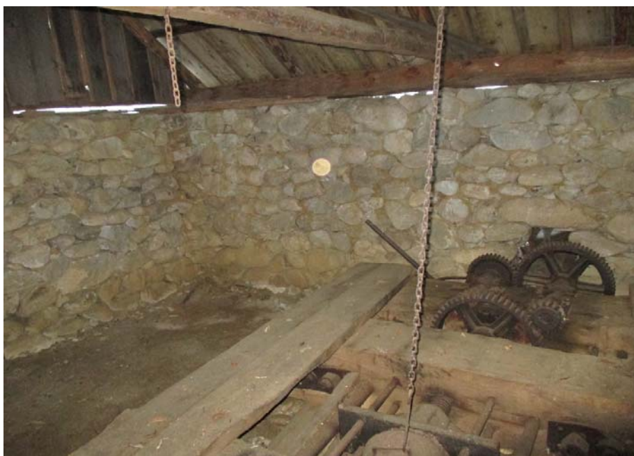
Fig.10. Pârghia care acționează manual dispozitivul lagărului de transmisie
